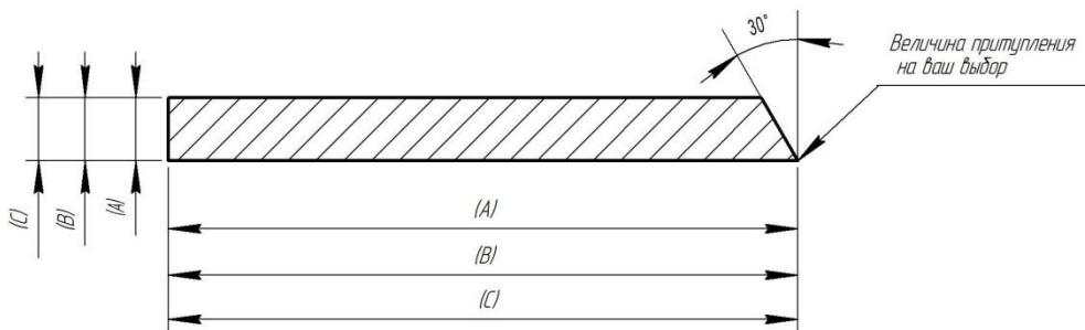
Разделка кромок на детали фрезеруется
